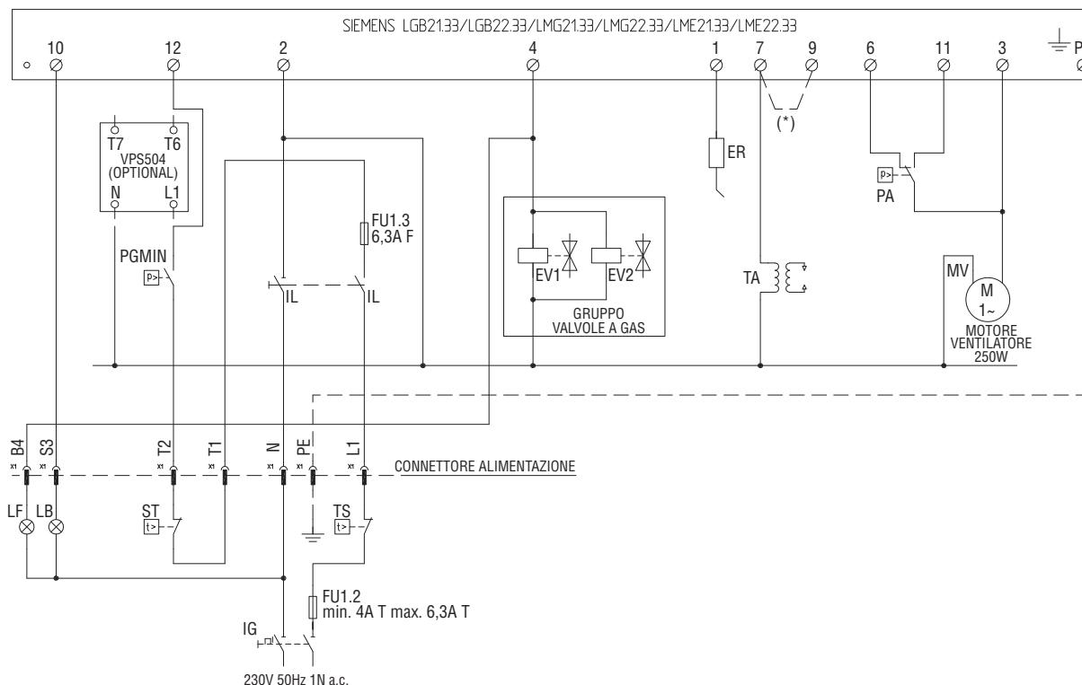
**N.B. Fare ponte tra i morsetti 7 e 9 solo quando si usa l'apparecchiatura SIEMENS LGB21.330**
